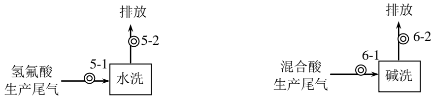
图 3-21 项目氢氟酸、混合酸生产尾气处理-排放流程图（◎为监测点位）
